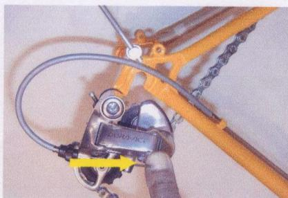
車輪を外した状態で、後変速機を上から押して下さい。
